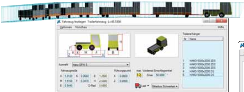
Individuelle Eingabe von Abmessungen für ein Trailerfahrzeug mit Anhängern
